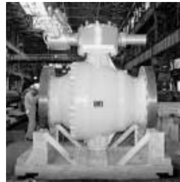
写真1 従来型ボールバルブ(800A) Photo 1 Traditional ball valve (800A)
