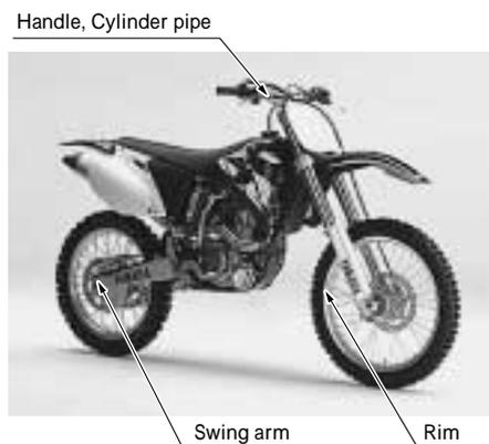
写真1 二輪車に採用されている代表的なアルミニウム押出材
