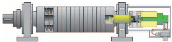
図4 第一世代 ディスク型形状検出ローラ Fig. 4 First generation disk type roller
