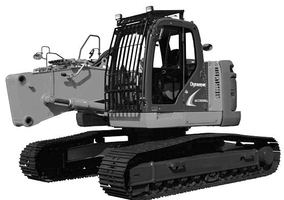
図1 SK235SRメインブーム兼用型解体の本体
