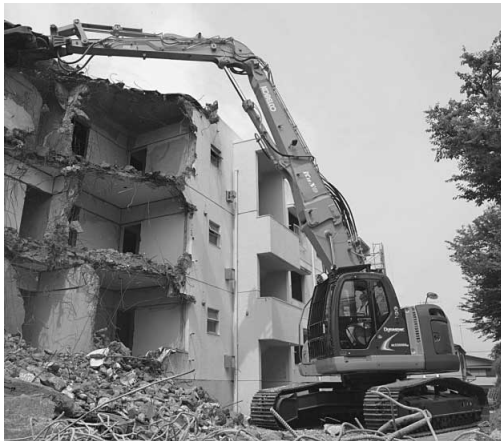
図16 SK235SRDLC 二つ折れ超ロングアタッチメント仕様機 Fig.16 SK235SRDLC 2 piece ultra long attachment machine
