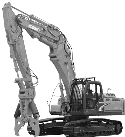
図4 SK260DLC セパレートブーム仕様機 Fig. 4 Separate boom machine of SK260DLC
