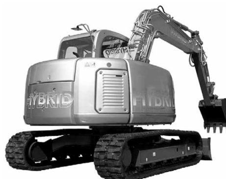
図1 INTERMAT2006パリ建機展に出展した世界初のハイブリッド油圧ショベルSK80H
