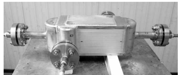
図8 ASME規格合格のDCHE
