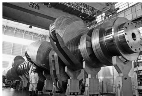
図2 組立型クランク軸 Fig. 2 Built-up type crankshaft
