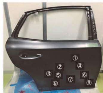
図8 サイドドアアウトパネルの張り剛性試験と試験箇所 Fig. 8 Flare rigidity test for outer panel of side door and testing points
