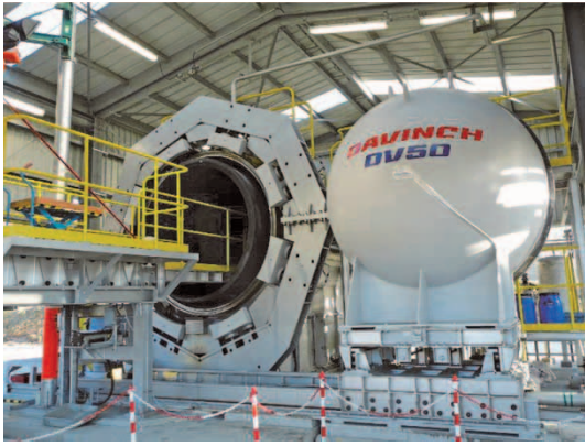
図5 ベルギー軍プールカペッレ基地に納入した爆破チャンバ Fig.5 Detonation chamber delivered to Poelkapelle, Belgium
