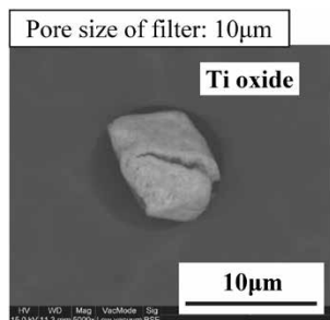
図5 混酸処理後のフィルタ上のTi酸化物 Fig.5 Ti oxide on filter after mixed acid treatment
