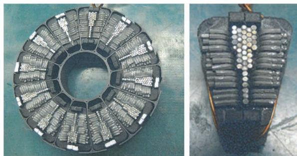
図 3 試作 AGM の外観 Fig.3 Photograph of the axial gap motor
