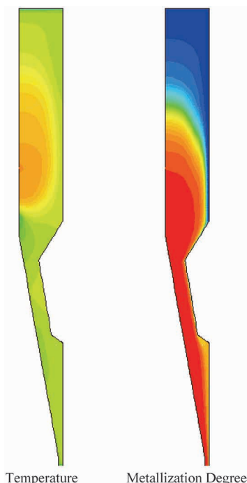
図1 シャフト炉内解析結果の例 Fig.1 Result of CFD analysis for shaft furnace
