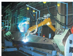
V型50度開先、多層盛3パス溶接
