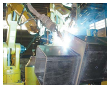
板厚・径違い柱 (模擬ワークによるイメージ)
