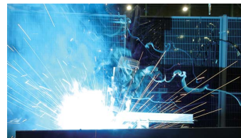
通常の炭酸ガスアーク溶接
