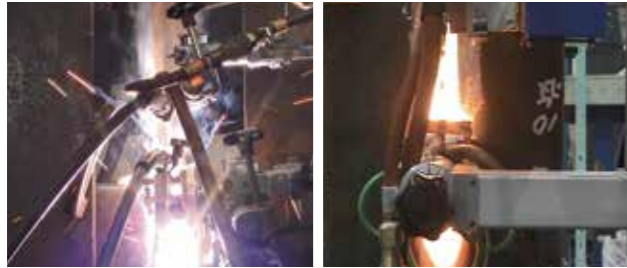
ESW：エレクトロスラグ溶接 EGW：エレクトロガスアーク溶接 ※ SESLA™ はエレクトロスラグ溶接です
